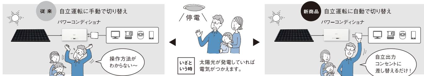
※7.1500Wが上限です。屋内用パワーコンディショナはコンセントを搭載しています。コンセントの位置は機種によって異なります。屋外用パワーコンディショナの場合は、自立運転コンセントを屋内に設置できます。配線工事が必要です。パワーコンディショナを設置する際、工事店にご相談ください。※8.テレビ視聴にはブースタ等の周辺機器にも電源が必要な場合があります。※9.自動切替には、予め設定が必要です。屋外用マルチストリング型パワーコンディショナ 品番:VBPC246B3、VBPC259B3等は停電時、自立運転への切替は手動のみです。
